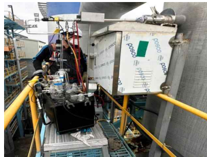
물품 추락 방지 부재 및 측정자의 안전을 고려하지 않은 측정공 위치
