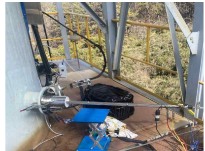
물품 추락 방지 부재 및 측정자의 안전을 고려하지 않은 측정공 위치
